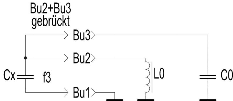
Der Parallelkreis ist resonant bei  $\omega_3 = 2\pi f_3$  mit  $\omega_3 < \omega_1$ , wobei die wirksame Kapazität ( $C_0 + C_x$ ) ist.
