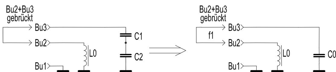
Damit ergibt sich  $C_0$  zu:  $C_0 = \frac{C_1 C_2}{C_1 + C_2}$ .
