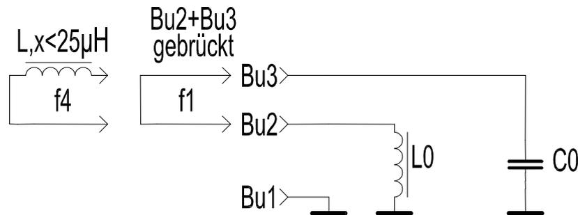
Der Parallelkreis ist resonant bei  $\omega_4 = 2\pi f_4$  mit  $\omega_4 < \omega_1$ , wobei die wirksame Induktivität bei einer Reihenschaltung der Induktivitäten ( $L_0 + L_x$ ) ist.
