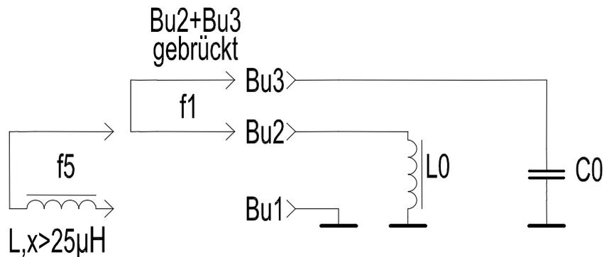
Der Parallelkreis ist resonant bei  $\omega_5 = 2\pi f_5$  mit  $\omega_5 > \omega_1$ , wobei sich die wirksame Induktivität bei einer Parallelschaltung von  $L_0$  und  $L_x$  aus
