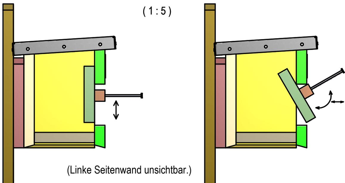
Zum Inspizieren Aushebesicherung ausschrauben sowie Vorderwand nach oben schieben und nach vorn ausschwenken.
